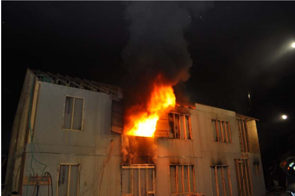
Afbeelding 10: onderzoek naar impact van horizontale ventilatie. ©Underwriters Laboratories.
