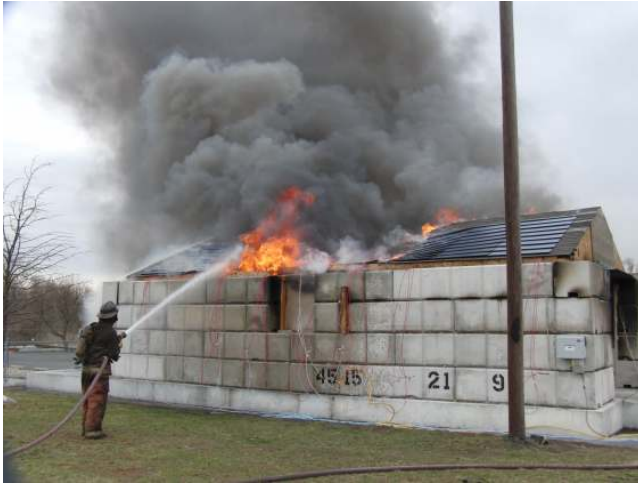
Afbeelding 3: brandproef zolderbrand met fotovoltaïsche panelen. ©Underwriters Laboratories Inc.
