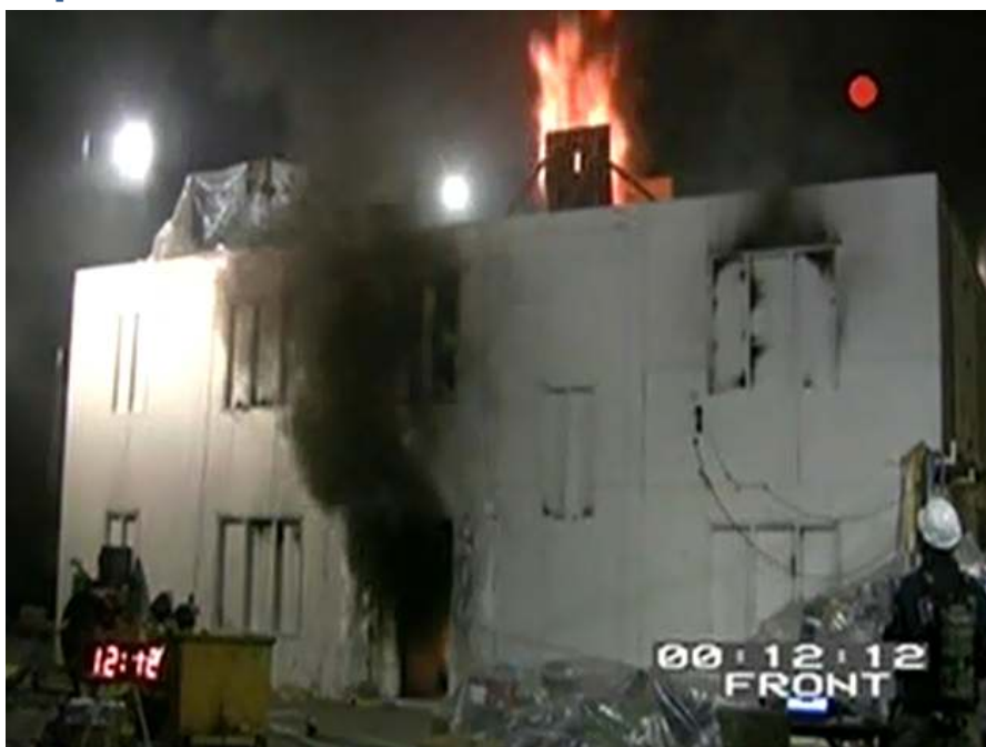
Afbeelding 12: brandproef om effect ventilatie te onderzoeken. ©Underwriters Laboratories Inc.
