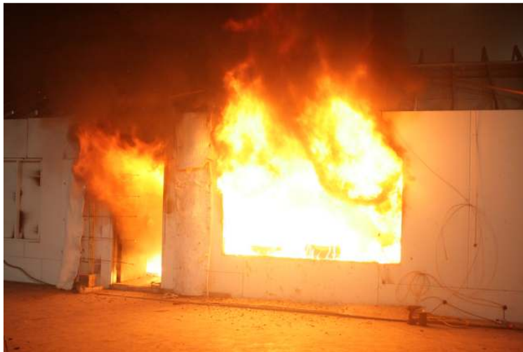
Afbeelding 9: brandproef om effect horizontale ventilatie te onderzoeken. ©Underwriters Laboratories Inc.
