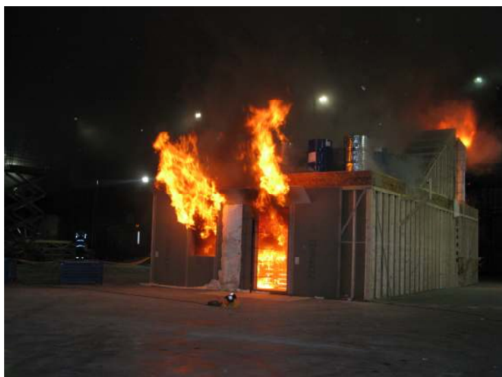
Afbeelding 5: brandproeven om stabiliteit van lichtgewicht houten vloerconstructies bij brand te testen. ©Underwriters Laboratories.
