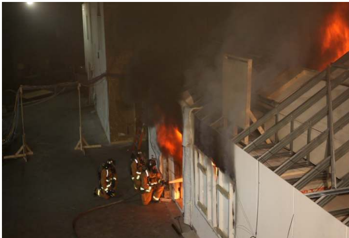
Afbeelding 14: Brandproef om impact van verticale ventilatie te onderzoeken. ©Underwriters Laboratories.
