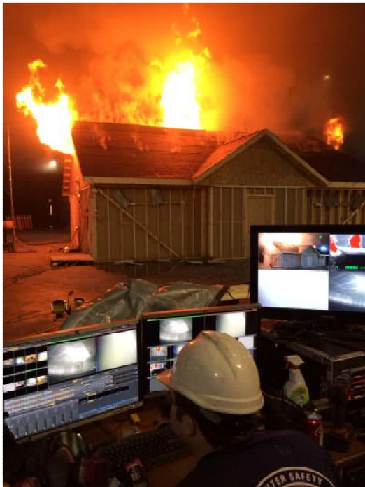
Afbeelding 16: Brandproeven in verband met zolderbranden en branduitbreiding langs buiten. ©Underwriter Laboratories.
