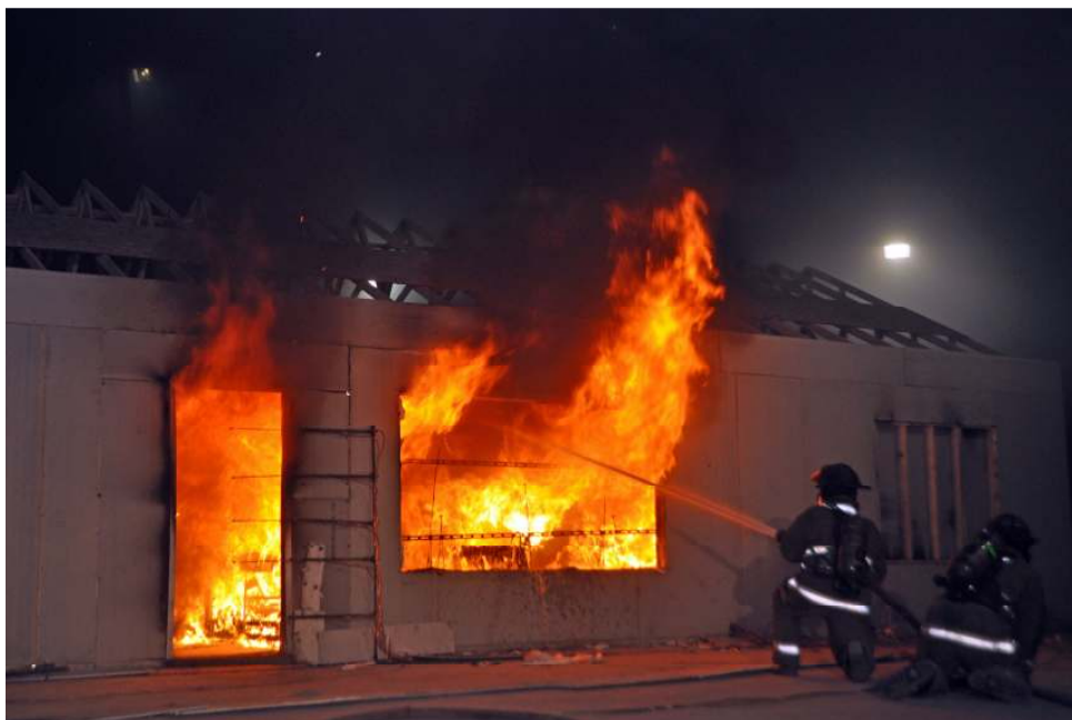
Afbeelding 11: onderzoek naar invloed horizontale ventilatie. ©Underwriters Laboratories.
