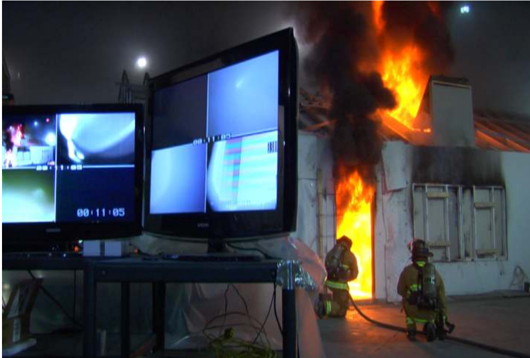
Afbeelding 13: brandproef om impact verticale ventilatie op brandverloop te onderzoeken. ©Underwriters Laboratories.
